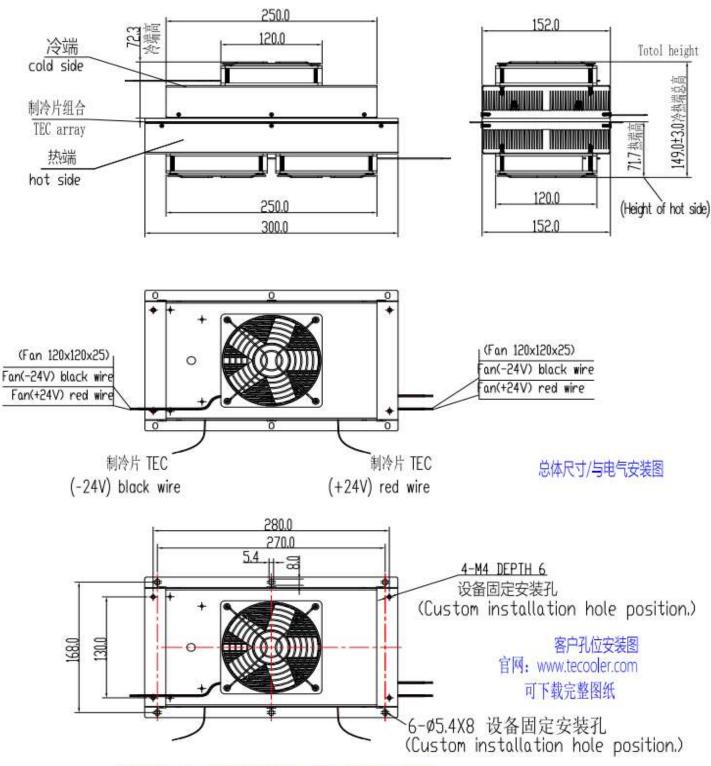
安装方法: 开一个略比152X250mm稍大的槽,把冷端放进去,再配合固定安装孔来安装固定。
